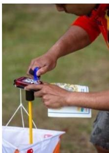
Para marcar los puestos deberán introducir el SiCard dentro del orificio de la base, esperar a que emita un pitido y/o haga un sonido.
